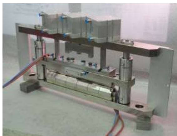
Obr. Střížný nástroj s integrovaným svařováním sáčků
