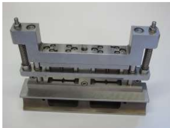
Obr. Střížná jednotka do baličky s odsáváním odpadu po stříhu
