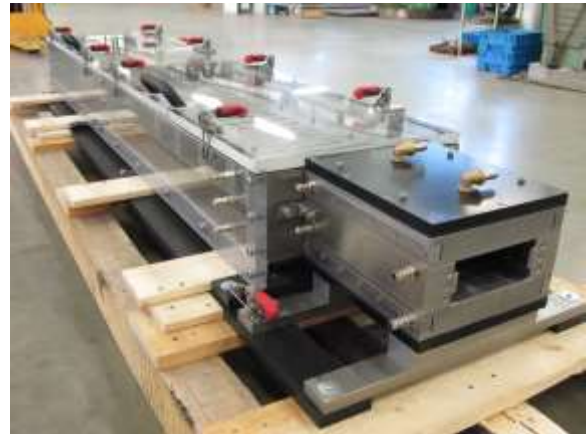
Obr. Kalibrační a chladicí část extruzního nástroje připravená k odvezení na zkoušky u zákazníka
