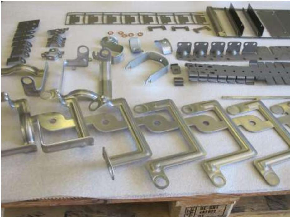
*Abb. Beispiele für Teile aus Stanzfolgewerkzeugen*
