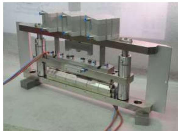
*Abb. Schneidwerkzeug mit integriertem Schweißen der Tüten*
