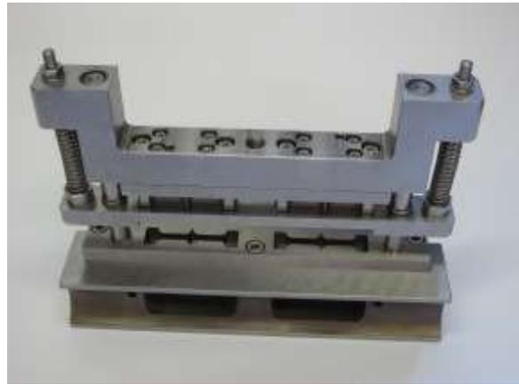
*Abb. Schneideinheit einer Verpackungslinie mit Absaugen des Abfalls nach dem Schnitt*
