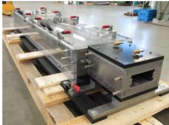
*Abb. Kalibrier- und Kühlteil des Extrusionswerkzeugs bereit zum Transport zur Überprüfung beim Kunden*
