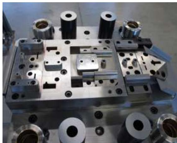
*Abb. Zweireihen-Folgewerkzeug – Montage*
