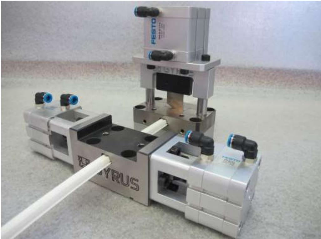
*Abb. Werkzeug zum Ausschneiden und Abschneiden von Kunststoffprofilen*
