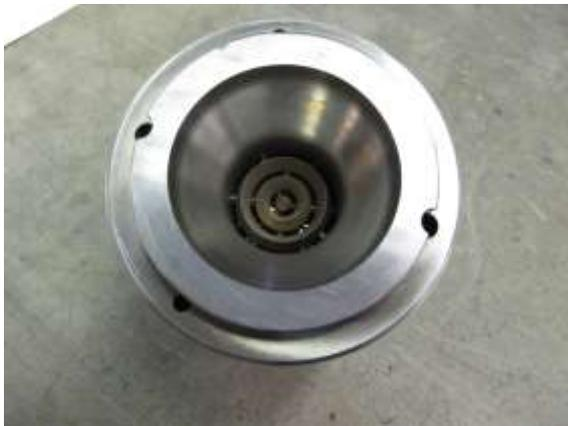
*Abb. Düse eines Extrusionswerkzeugs 1
