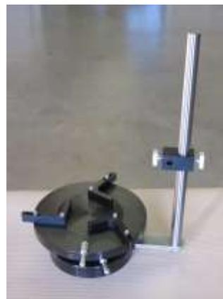
Abb. Vorrichtung zum Messen der Flaschen-Lotrechtigkeit für die Glasindustrie
