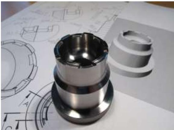
*Abb. Werkzeug für das Pressen von Keramik*
