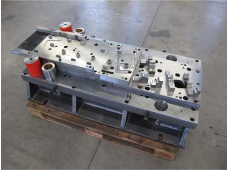
*Abb. Montage des Folgewerkzeugs*
