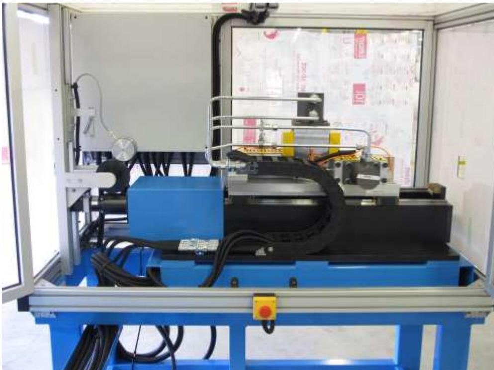
*Abb. Perforiermaschine für ein kontinuierlich gezogenes Kunststoffprofil*
