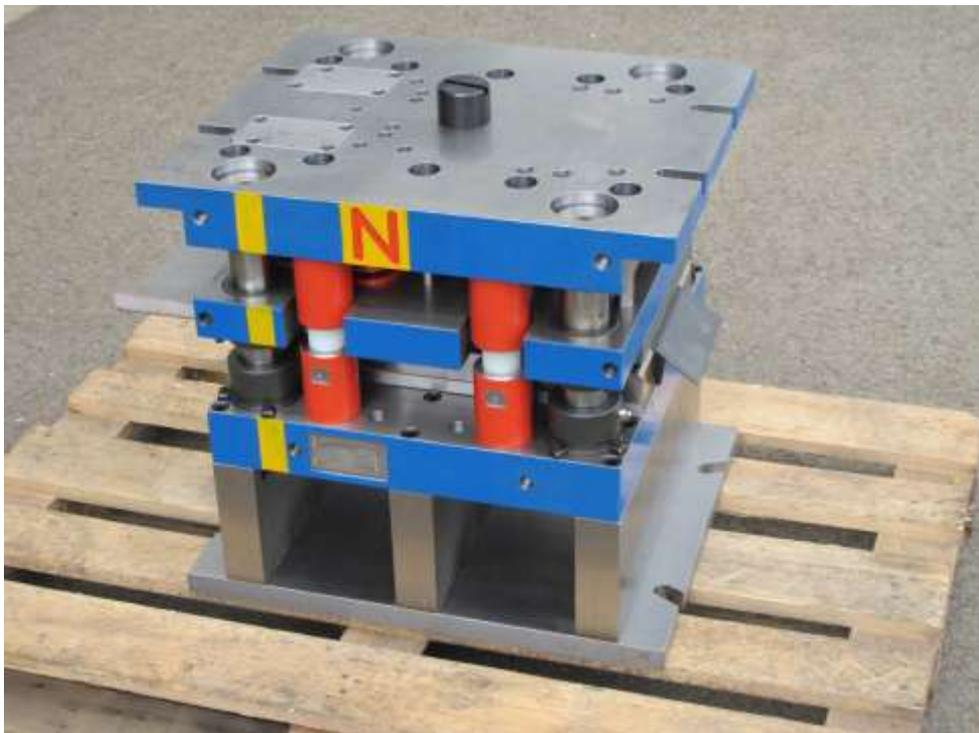
*Abb. Stanzwerkzeug bereit zur Überprüfung*
