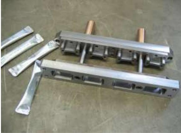
*Abb. Schneidwerkzeug für Lebensmittelverpackungslinie*
